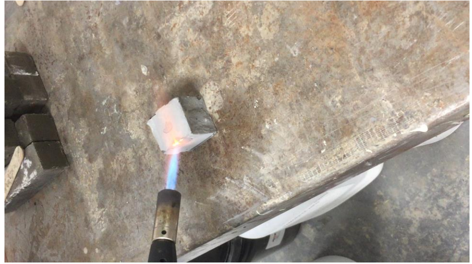
Sement eksponert for samme varme resulterte i eksplosiv avskalling
